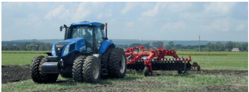
Рисунок 2 – Загальний вигляд ґрунтообробного агрегата New Holland T8.390 + ДЛМ-8,0
