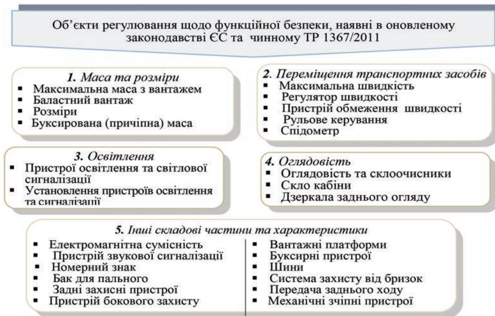
Рисунок 4 – Об'єкти регулювання щодо функційної безпеки (компоненти та характеристики, укладені за 5-ма групами), до яких установлюються вимоги, наявні і в чинному TP 1367/2011
