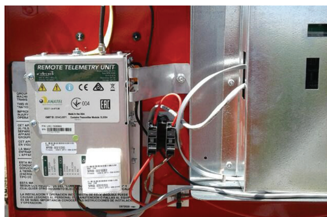
Рисунок 2 – Панель управління «Vision», розміщення блоку RTU в панелі керування кругової дощувальної машини Zimmatic
