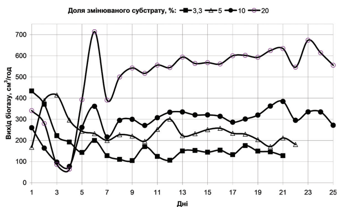
Рисунок 3 – Генерація біогазу за поступового завантаження субстрату
