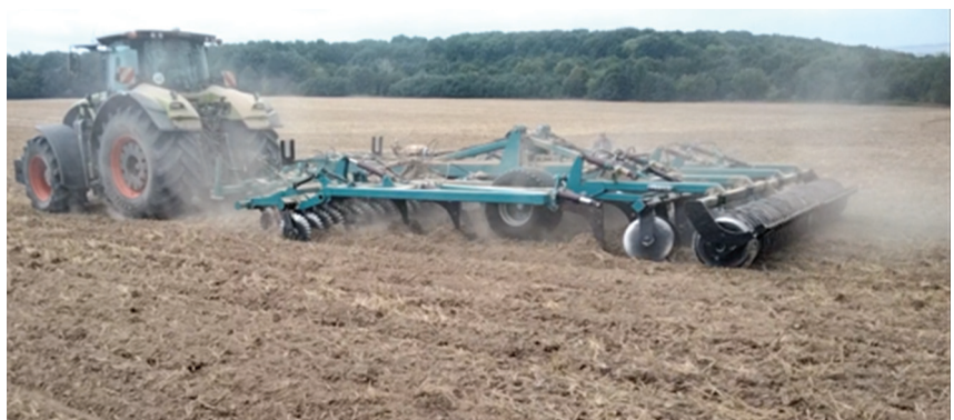
Рисунок 3 – Робота диско-чизеля ДЧ-4,5 у польових умовах
