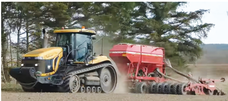
Рисунок 2 – Комбінований ґрунтообробний посівний агрегат на базі трактора Challenger MT 875 B та посівного комплексу Агро-Союз Horsh
