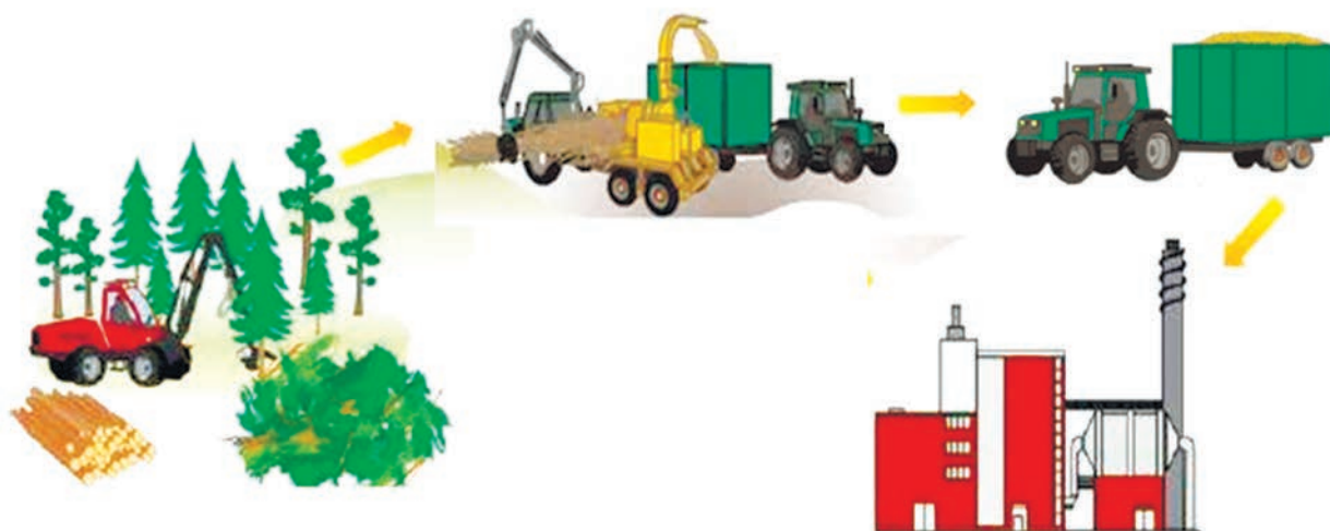
Рисунок 1 – Схема потокової технології виробництва тріски з порубкових залишків
