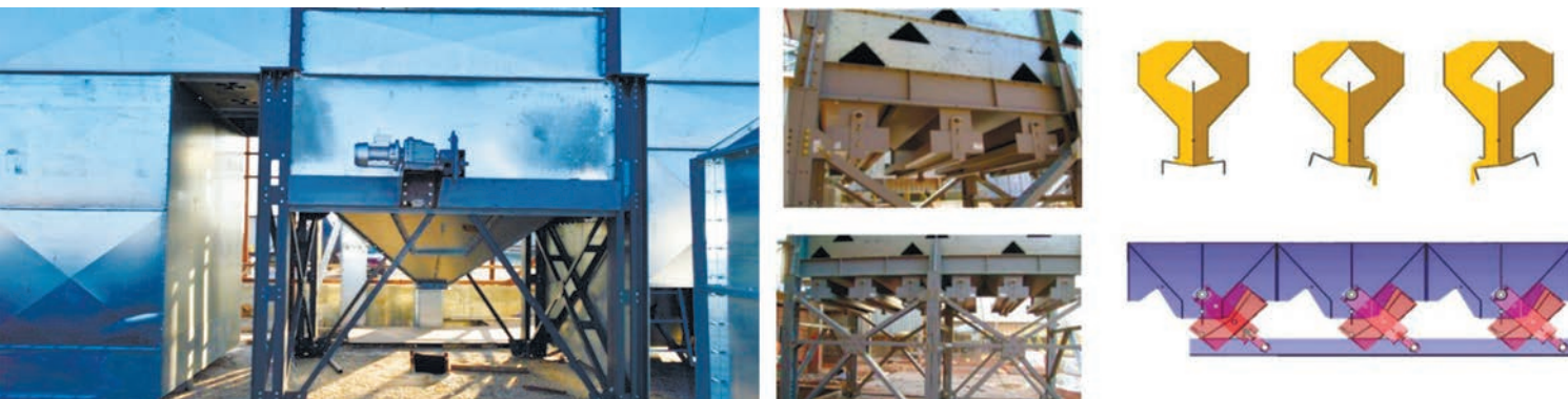
Рисунок 3 – Вивантажувальна система та опорна конструкція зерносушарки типу «Тор»
