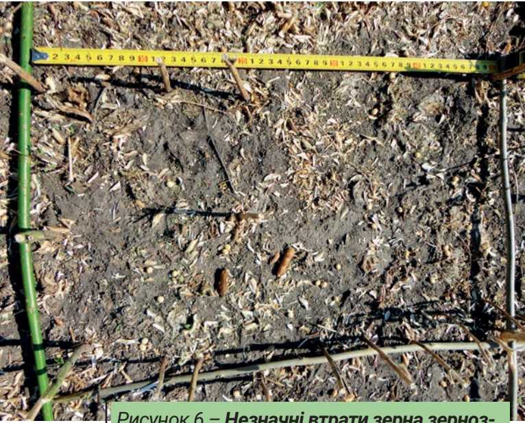
Рисунок 6 – Незначні втрати зерна зернозбирального комбайна під час скошування сої спеціалізованою соєвою жаткою
