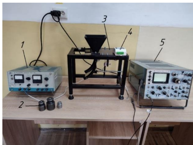
Рисунок 1 – Гравітаційний дозатор з вимірювальною системою
