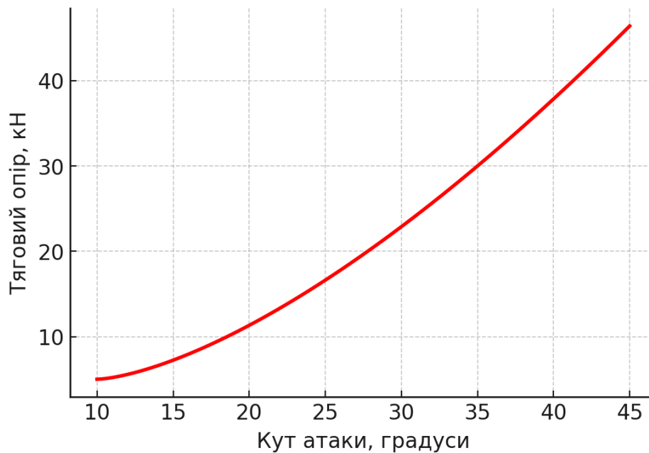
Рисунок 2 - Графік залежності тягового опору від кута атаки
