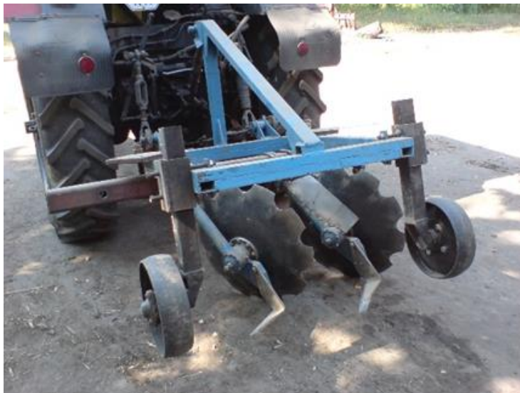
Рисунок 2 - Загальний вигляд дослідної установки для перевірки агротехнологічних показників обробітку ґрунту
