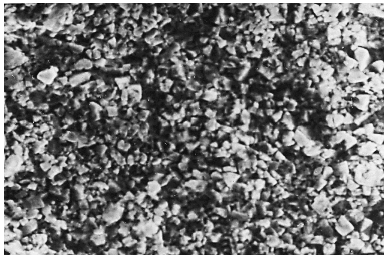
Рисунок 2 - Поверхня тертя твердого сплаву системи WC-Co, X1000
