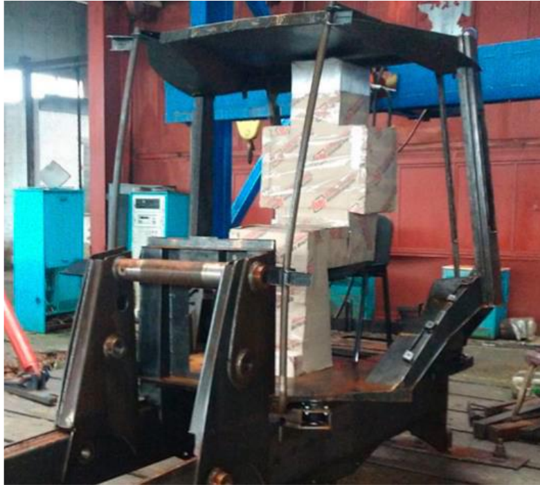
Рисунок 2 – Захисна конструкція (каркас кабіни ЕП-50.01.10.000) після проведення випробувань ROPS
