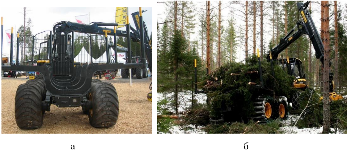
Рисунок 2 – Форвардер з системою VLA: а) загальний вигляд; б) під час виконання технологічного процесу
