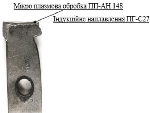
Рисунок 2 – Мікро плазмова обробка торцевої поверхні і крайки молотка порошковим дротом ПП – АН 148 (індукційне наплавлення твердим сплавом ПГ – С27); (КДУ-2,0; ДБ-5, ДКМ-5)
